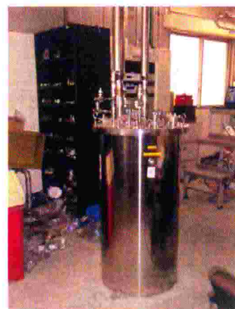
図 3 : ガス温度調整用バッファ装置
