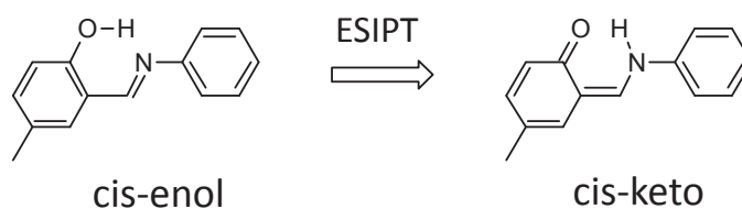
図3 MSA の cis-enol 型を励起すると ESIPT が起こり、cis-keto 型が生成する。
